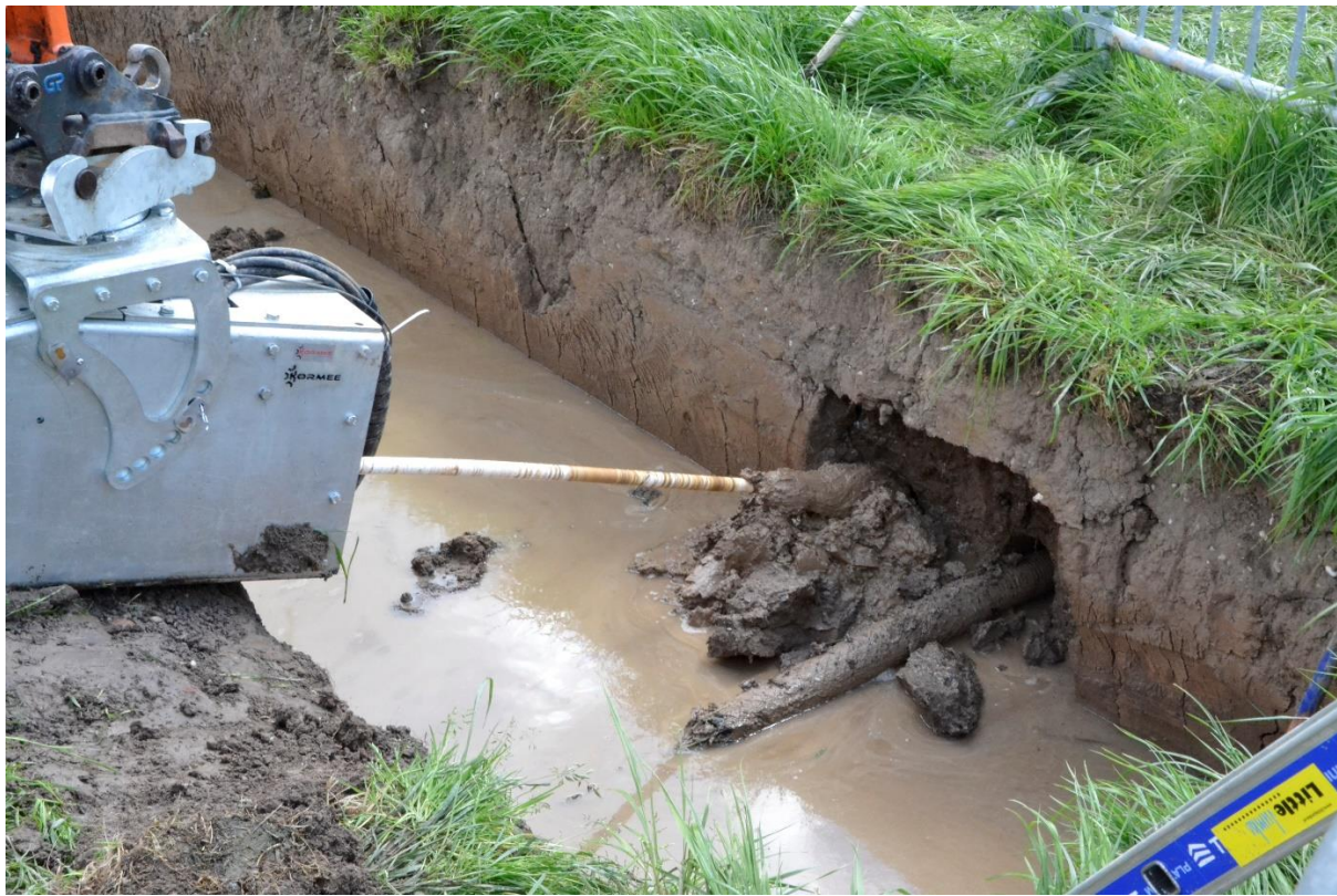
Figuur 3: Tweede testboring in klei met krachtopnemer tijdens doortrekken van mantelbuis
