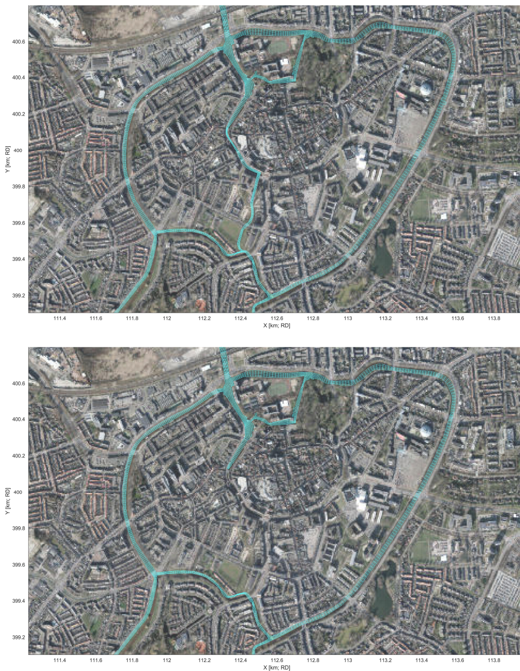
Figuur 11: Boven: Detail van het rekenrooster voor de singels met de Nieuwe Mark en Onder: Detail van het rekenrooster voor de singels zonder de Nieuwe Mark
