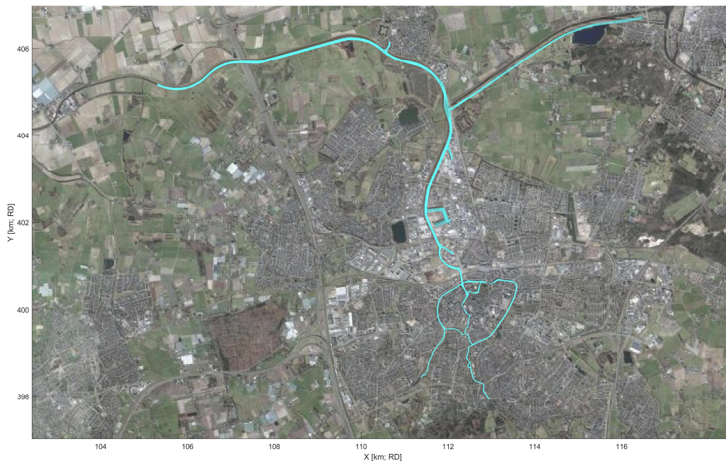
Figuur 10: Boven: Volledige rekenrooster van het D-FLOW FM model voor Breda. De cirkelvormige geometrie representeren de singels en omsluiten het centrum van Breda.
