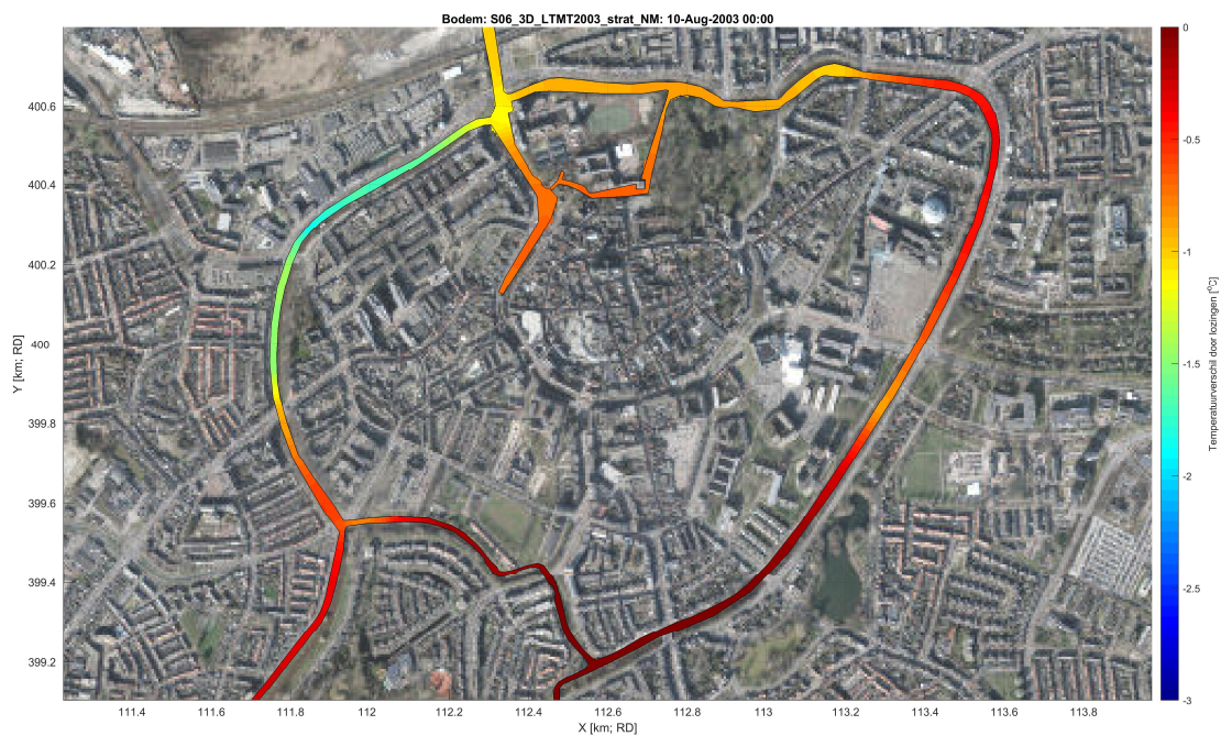
Figuur 19: Effect van de lozingen op de watertemperatuur nabij de bodem in de singels op 10 augustus 2003 voor het LT+MT scenario waar de lozingen gestratificeerd zijn ingebracht.
