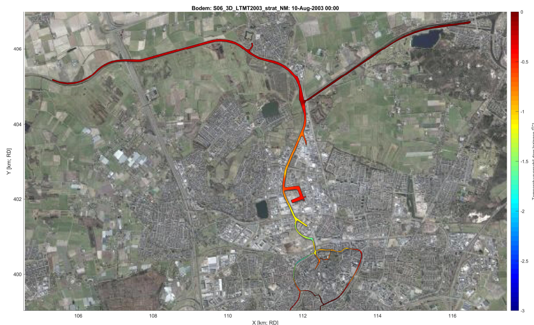
Figuur 18: Effect van de lozingen op de watertemperatuur bij de bodem op 10 augustus 2003 voor het LT+MT scenario waar de lozingen gestratificeerd zijn ingebracht. Het grootste cumulatieve effect is vooral zichtbaar benedenstrooms van de Spoorbrug en ter hoogte van de Belcrum Haven. Benedenstrooms is de temperatuur van het omgevingswater weer aangenomen.
